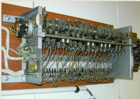
L'arbre à cames et ses rupteurs au mercure
